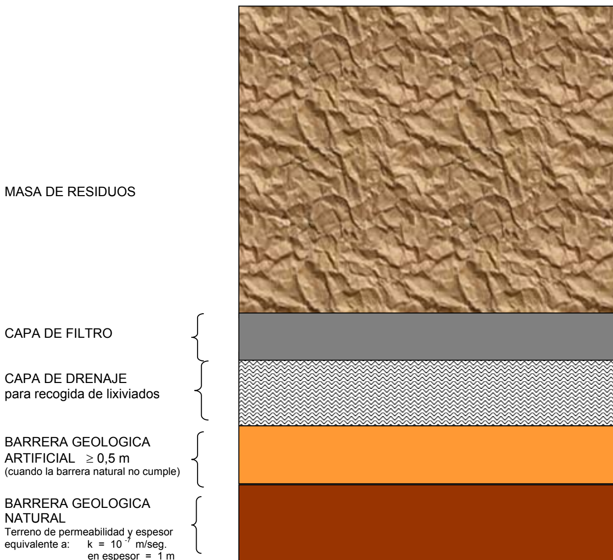
Figura 5.1.- Vertederos de residuos inertes. (Solución de Referencia)
